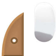
estèques F ribs Outils de bois, de métal ou de plastique, servant à lisser la surface externe de l'objet lors du tournage.
