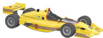
Depuis 1975 Révolution aérodynamique : on assiste à l'apparition des ailerons et de l'effet de sol qui colle les voitures à la piste. Les moteurs de 8 cylindres sont turbocompressés.
