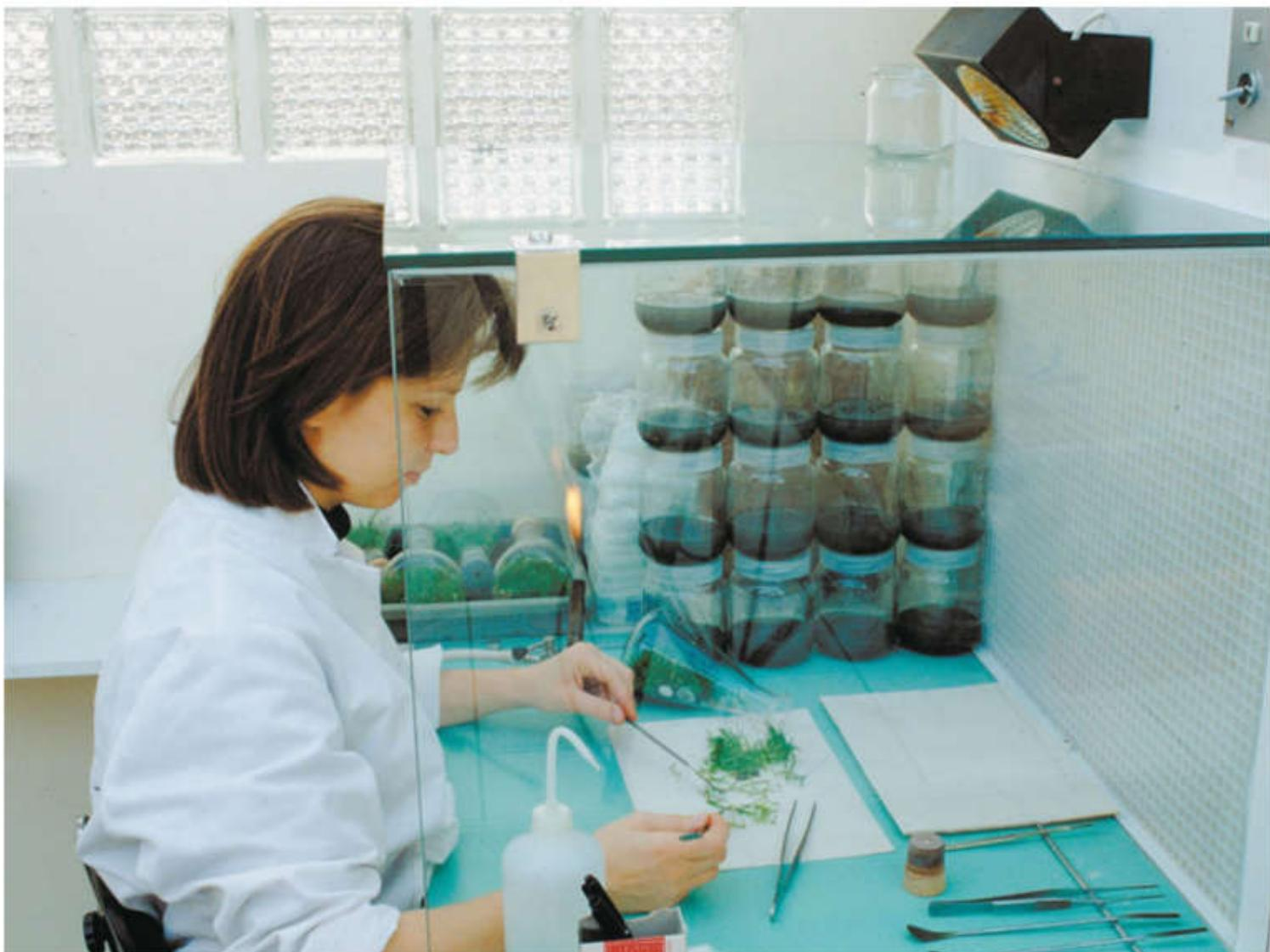
Les laboratoires sont équipés d'enceintes à flux laminaire, sortes de hottes vitrées alimentées par l'air passant par des filtres absolus de l'ordre de 0,3 micron, retenant les spores et les bactéries. Ces appareils sont utilisés en pièces de travail entièrement stériles.
