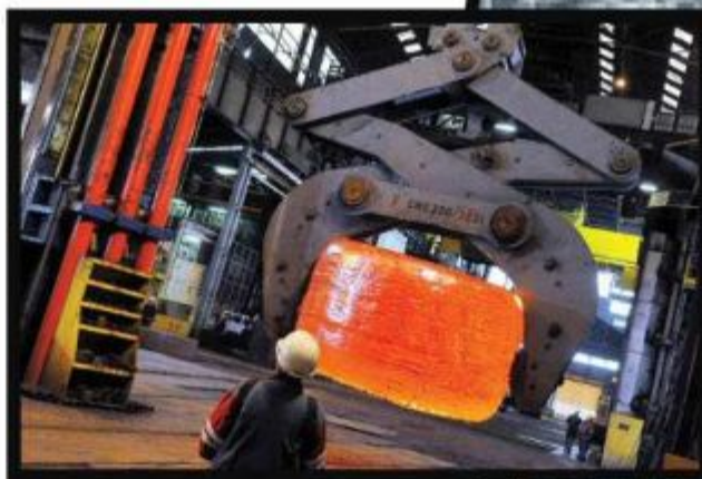
△ Forcée à l'usine Creusot Forge d'Areva à partir de 2006, la cuve souffre d'une importante anomalie due à la méthode employée pour le refroidissement.
