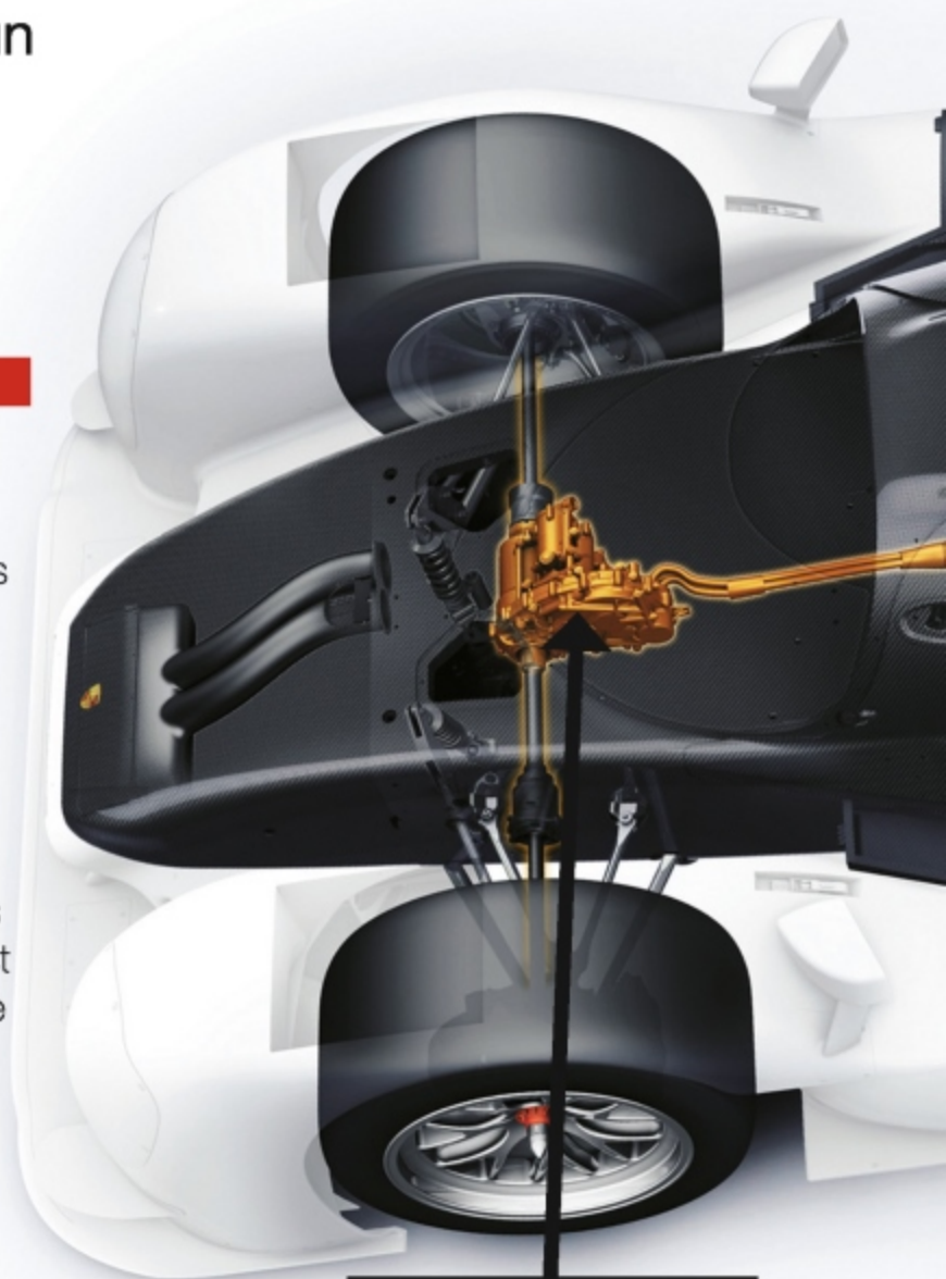
Le moteur électrique entraîne les roues avant lors des accélérations
