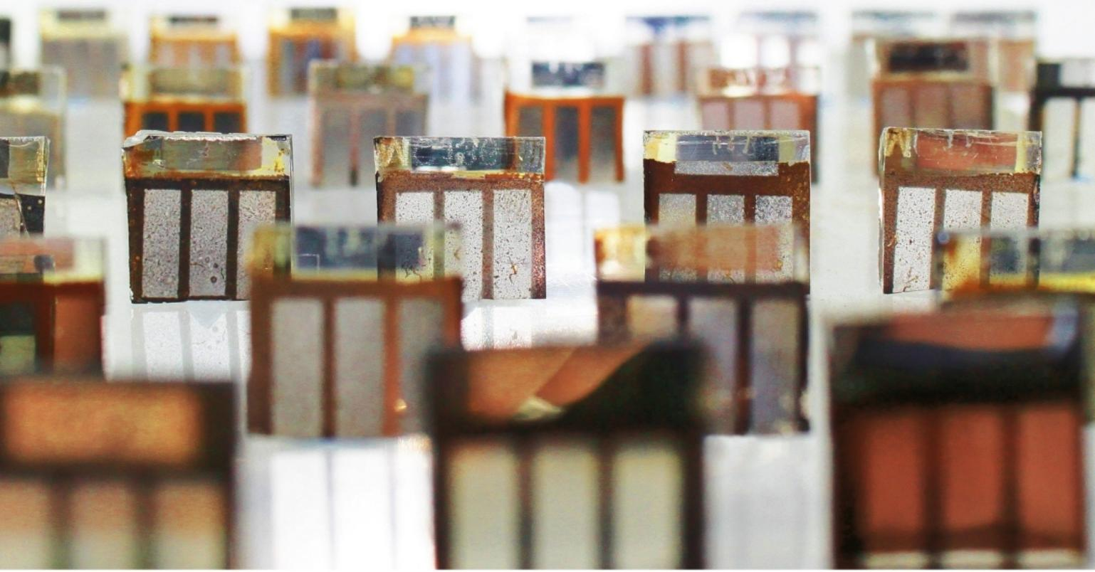
▲ Ces cellules photovoltaïques sont composées de pérovskite : mis au point en laboratoire, ce cristal a d'étonnantes propriétés de conductivité et d'absorption de la lumière.
