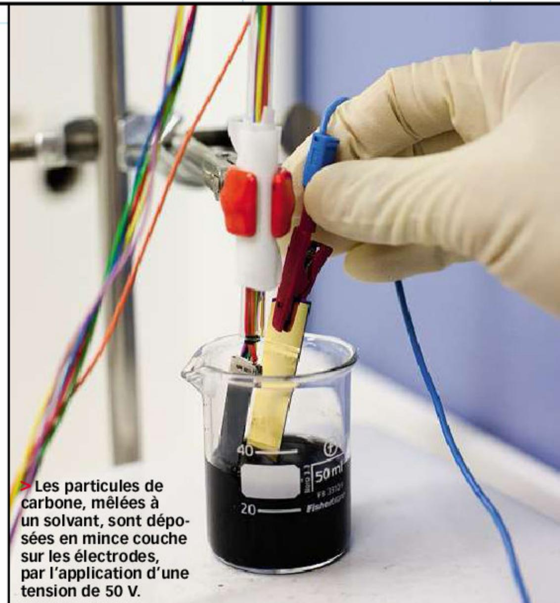
► Les particules de carbone, mêlées à un solvant, sont déposées en mince couche sur les électrodes, par l'application d'une tension de 50 V.
