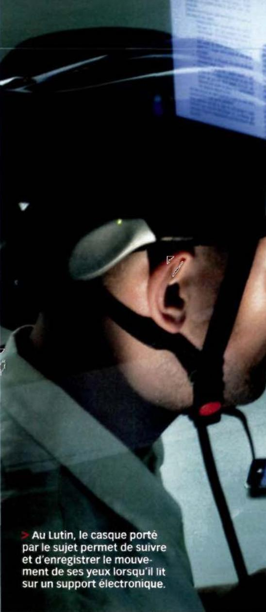
> Au Lutin, le casque porté par le sujet permet de suivre et d'enregistrer le mouvement de ses yeux lorsqu'il lit sur un support électronique.
