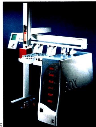
Un "nez" électronique analyse les molécules émises par le poisson: on détermine ainsi sa fraîcheur.
