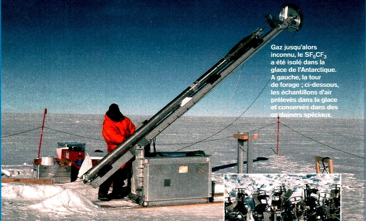
Gaz jusqu'alors inconnu, le  $SF_5CF_3$  a été isolé dans la glace de l'Antarctique. A gauche, la tour de forage ; ci-dessous, les échantillons d'air prélevés dans la glace et conservés dans des containers spéciaux.
