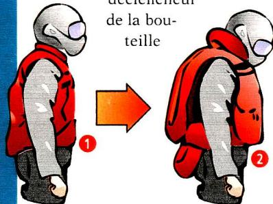
Le gilet gonflable **1** est doté d'une bouteille de gaz carbonique sous pression. Lorsque le motard chute, le gaz gonfle le gilet **2** grâce au déclencheur relié par un câble à la moto **3**. Le gilet pour travailler en altitude (ci-dessus) est équipé d'un capteur de gravité qui provoque son gonflement en cas de chute.
