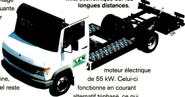
moteur électrique de 55 kW. Celui-ci fonctionne en courant alternatif triphasé, ce qui
