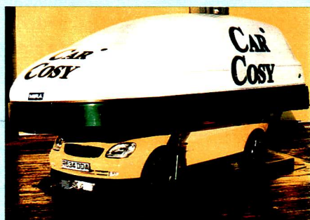
La coque de protection, en fibres de verre, se soulève grâce à des vérins.
