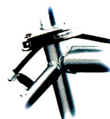
Soudure de cadre : tubes acier Hiten soudés TIG.
