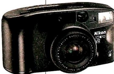
Voici le 24 x 36 Zoom 700 VR, premier appareil au monde à posséder un stabilisateur capable de compenser les effets d'un bougé lors du déclenchement de l'appareil. Pour maintenir l'image fixe sur l'émulsion sensible,
