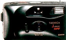
D'une grande simplicité, le Yashica J Mini Super se caractérise par son système de mise au point : pour la photo générale, il n'existe aucun réglage (objectif fix focus 3,5/32 mm), les images étant nettes de 1,40 m à l'infini ; ce n'est que pour le portrait qu'une touche permet de déplacer le système optique pour obtenir la netteté de 0,90 m à 1,40 m. Cet appareil Yashica assure, en outre, les vitesses de 1 s à 1/60 s et possède un flash utilisable de 1,70 m à 3,20 m.
