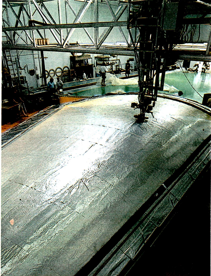
Pour faire une voile de bateau, on applique sur un moule un film de Kevlar, des fibres et un autre film. On chauffe, on cuit, et vogue le navire...
