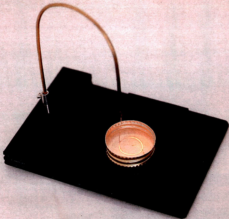
Le fil de platine reste incandescent sans qu'il y ait la moindre flamme
