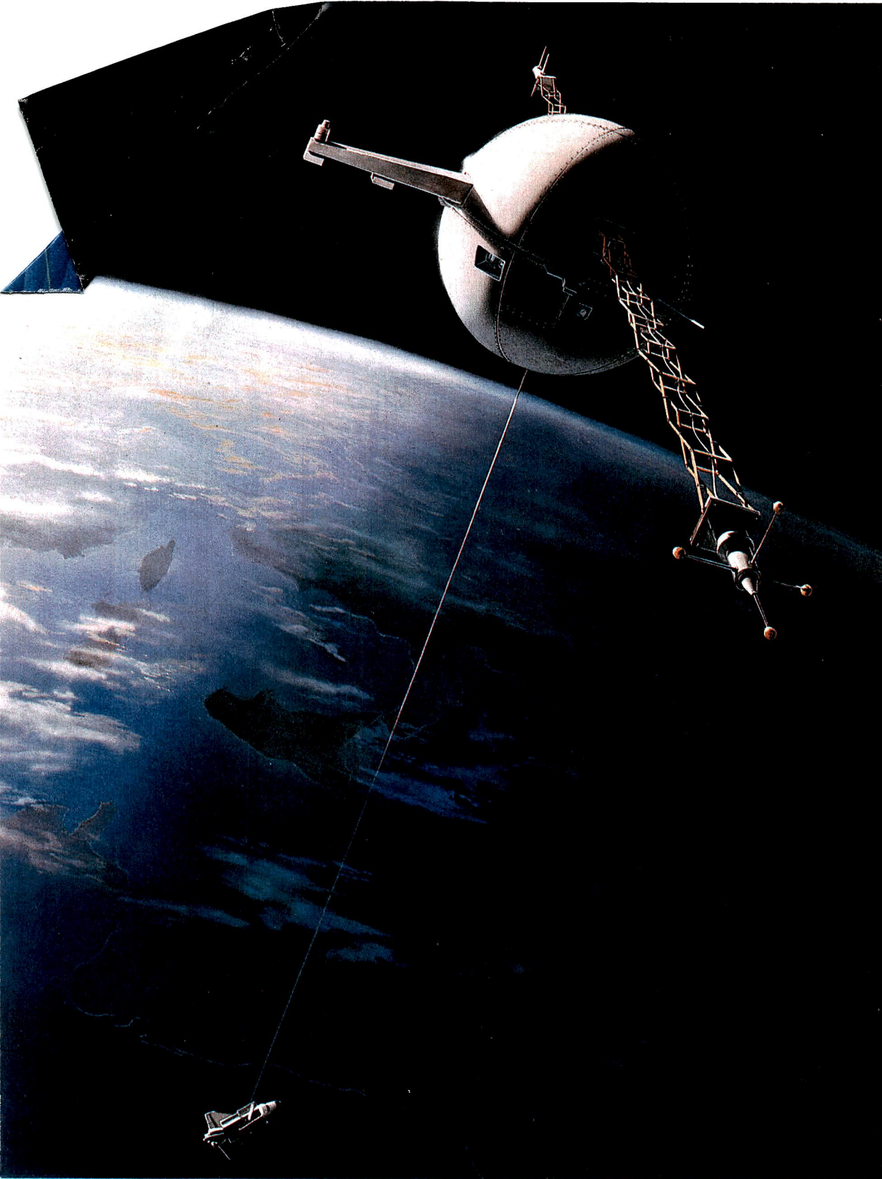
Un câble de 20 km reliera, en 1991, le premier TSS ( Tethered Satellite System , ou satellite captif) à la navette spatiale qui le larguera.
