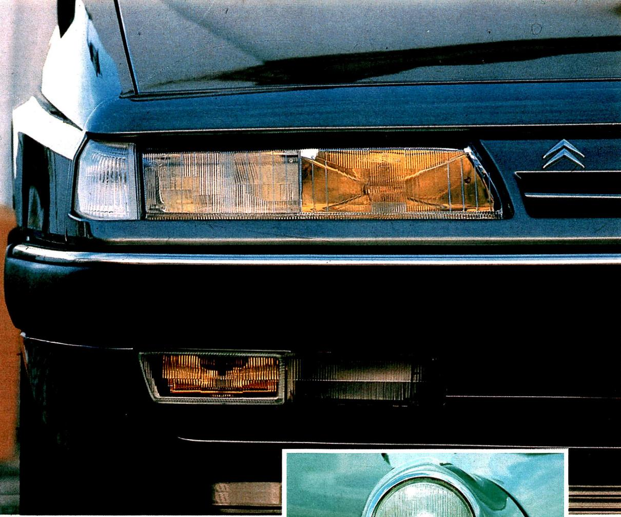
tion avec les projecteurs elliptiques. Le réflecteur n'est plus une parabole mais une demi-ellipse. Il récupère le flux émis en son premier foyer et concentre le rayonnement au deuxième foyer, confondu avec celui d'une lentille convergente placée devant lui. Cette lentille redresse le faisceau en rayons parallèles. Un masque vertical barre le passage aux rayons réfléchis vers le haut pour l'éclairage code.
