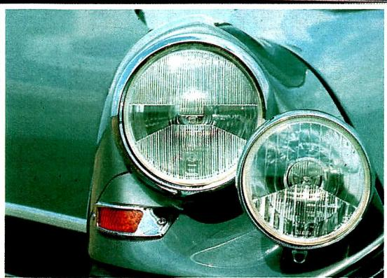
**De la DS à la XM.** Trente ans entre la technique des projecteurs encombrants et verticaux, et celle des phares minces, mieux intégrés et plus efficaces grâce aux réflecteurs à surface complexe ! Là, phares et codes peuvent être allumés simultanément.
