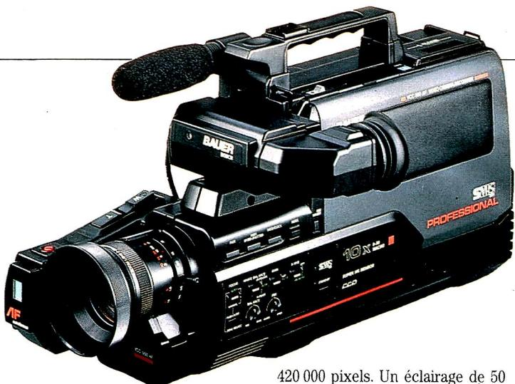
420 000 pixels. Un éclairage de 50 lux suffit pour filmer.
