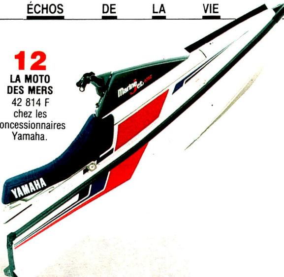
**12** Naviguer sur l'eau à deux à 60 km/h au moyen d'un scooter, c'est ce que propose Yamaha Marine avec le Marine-Jet 650 T. Cet engin, qui associe les caractéristiques d'une moto (moteur, siège, guidon) à celles d'un hydroglisseur (coque polyester, propulsion par réacteur à eau, sans hélice) est équipé d'un bi-cylindre Yamaha 650 cc 2 temps de 32 ch. Sa sécurité est maximale : si le pilote tombe, le moteur s'arrête automatiquement et le Marine-Jet s'immobilise en flottaison.
