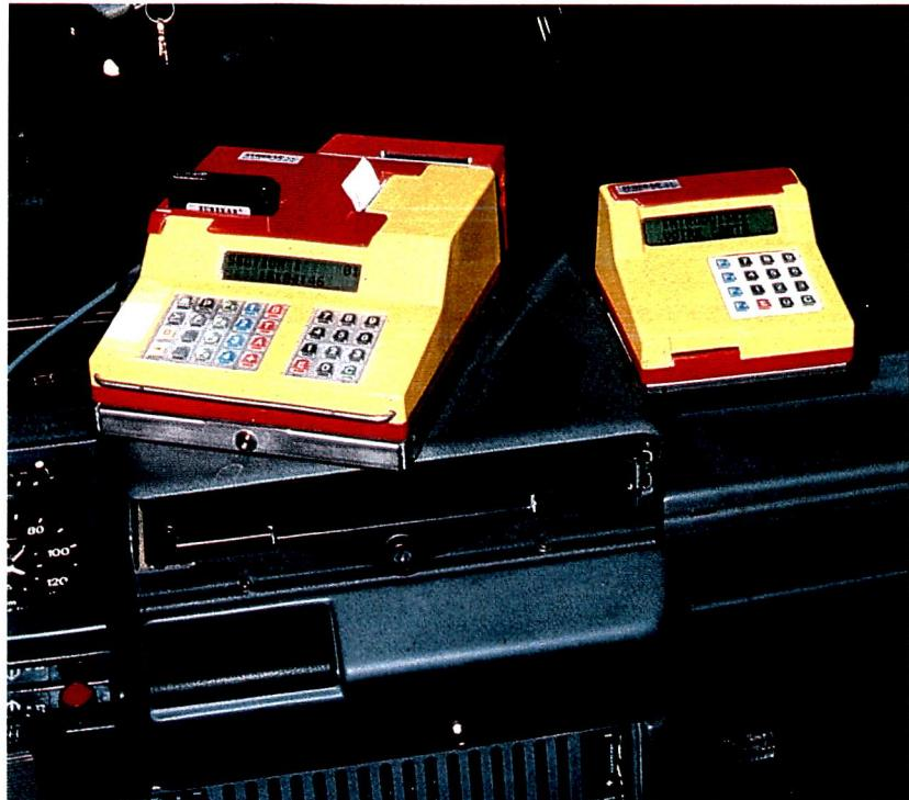
En montant dans le bus, le voyageur "compose" sa carte en l'introduisant dans le lecteur de droite, sur le clavier duquel il aura préalablement tapé sa destination. Le conducteur dispose d'un second boîtier où il indique la section qu'il traverse et qui peut lui permettre, éventuellement, de délivrer des titres de transport à l'unité. C'est sur ce boîtier qu'est enfiché le module mémoire (bloc noir).
