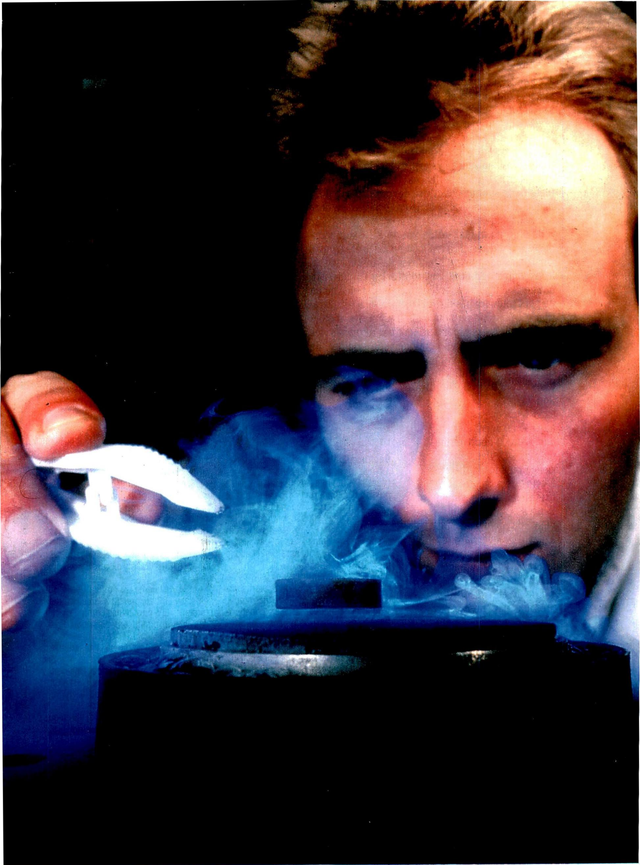
L'effet le plus spectaculaire de la supraconduction : la lévitation magnétique. Au Japon, un train existe déjà, qui flotte sur ses rails.
