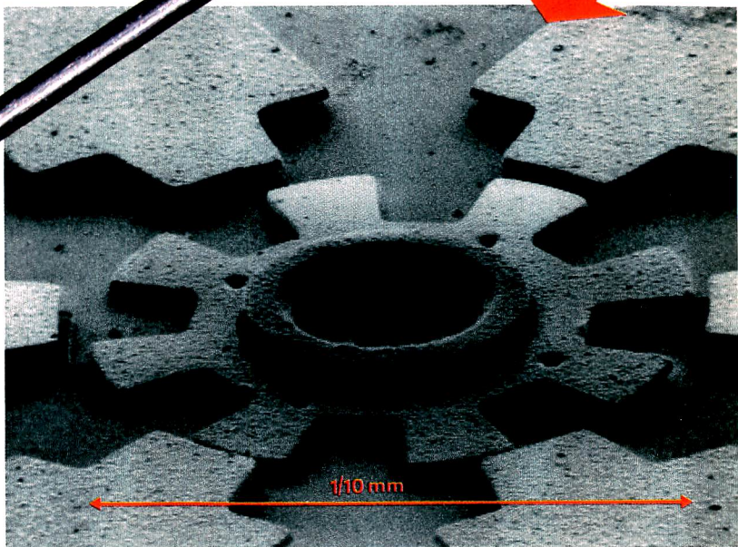
Dans le chas d'une aiguille à coudre, on ferait tenir plus d'une douzaine de ces moteurs électrostatiques construits avec la technique des circuits intégrés.
