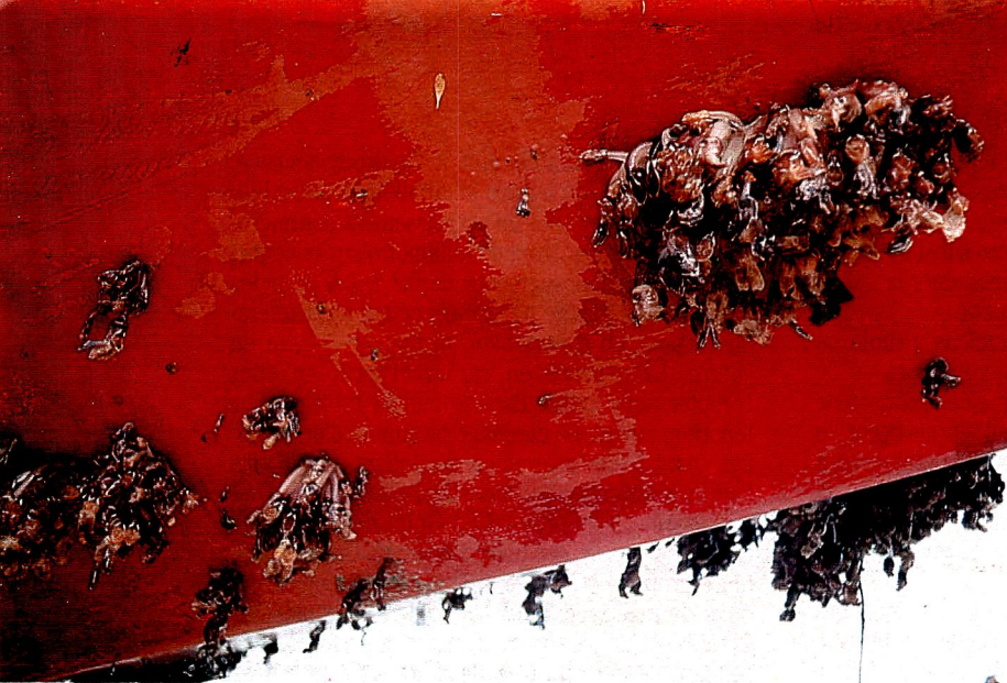
La peinture "antifouling" empêche les parasites végétaux et animaux de coloniser la coque des bateaux, mais pollue gravement l'environnement marin.
