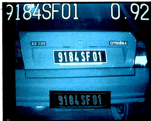
Le système Elsydel d'identification d'une plaque minéralogique repose sur la détection du contour du numéro à partir d'un cliché du véhicule.
