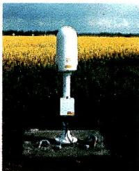
C'est dans le dôme de cette station de réception du réseau LLP, haute d'1,70 m, que se trouvent les antennes électriques et magnétiques qui capteront les signaux émis par la foudre.
