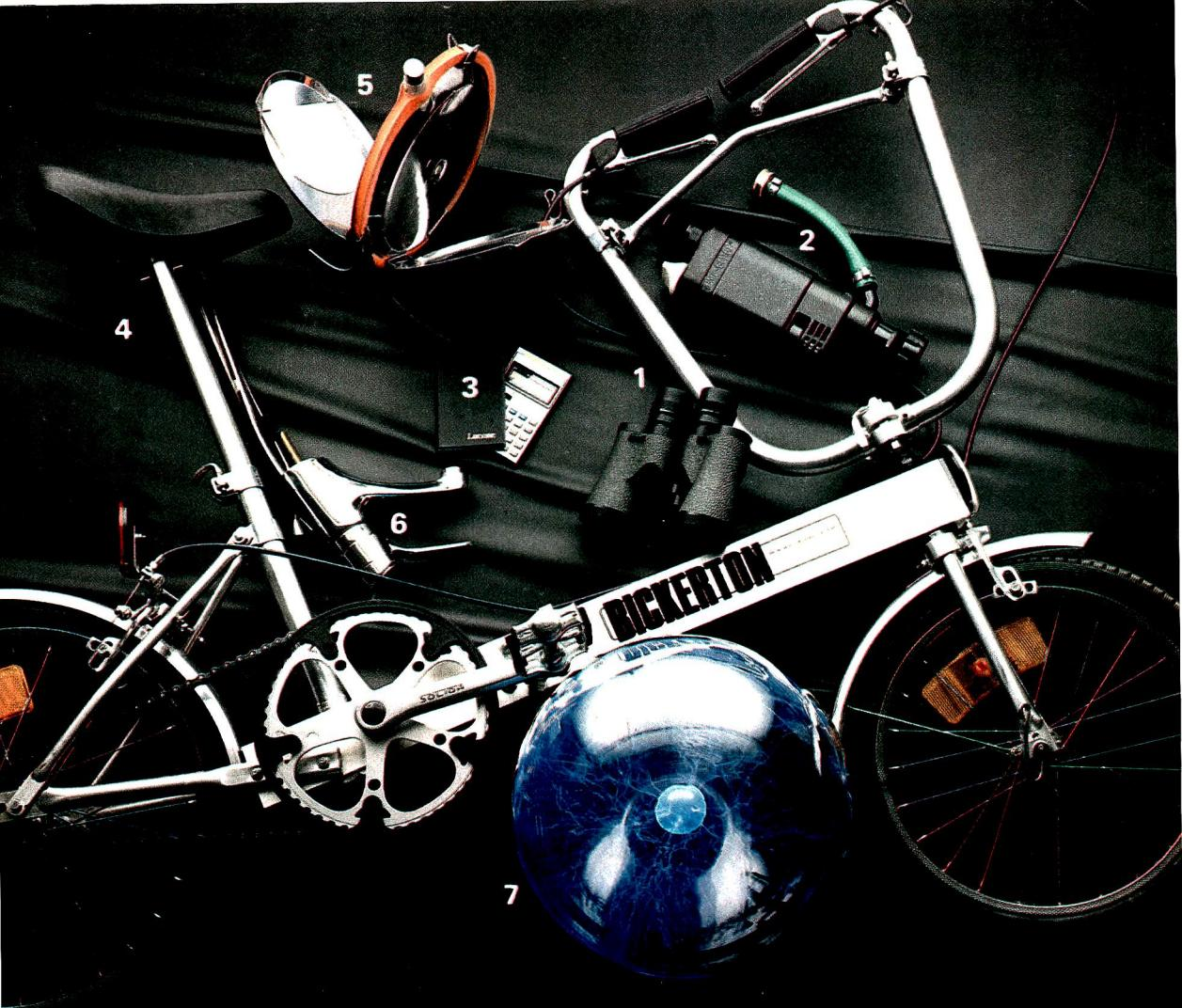
encombrement très réduit (76 x 51 x 25 cm) et ne pesant que 9 kg. La bicyclette est simple à plier. Au moment de l'utilisation, le cycliste effectue, sans outil et en quelques secondes, les réglages de la selle (matelassée) et du guidon qui lui permettent de choisir la position la mieux adaptée à sa taille. Fabriquée presqu'entièrement en alliage d'aluminium, les Bickerton ne nécessitent que peu d'entretien.
