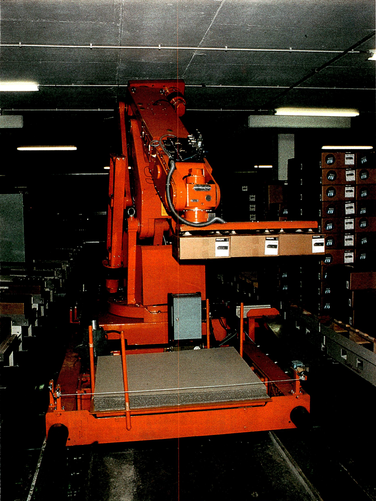
Dans l'usine Philips de Hasselt (Belgique), en fin de chaîne de fabrication, un robot trie et stocke suivant les différentes marques les lecteurs de disques compacts.
