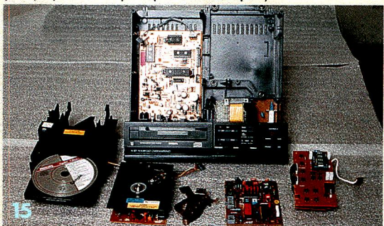
15. Les différents sous-ensembles composant un lecteur. Devant, de gauche à droite, le tiroir du disque, la platine, le bras laser, le circuit de platine, le circuit du tableau de bord. Derrière ; le tableau de bord et le boîtier.
