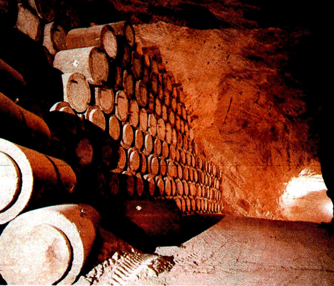
Si les déchets sont enfouis dans le sel, comme ici dans la mine d'Asse en RFA, les galeries se refermeront d'elles-mêmes.
