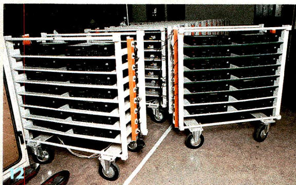
11. La platine opto-électronique et la carte de circuits sont assemblées dans le lecteur sur une chaîne de montage conventionnelle. 12. Avant une dernière vérification, les lecteurs achevés sont mis 24 heures sous tension.
