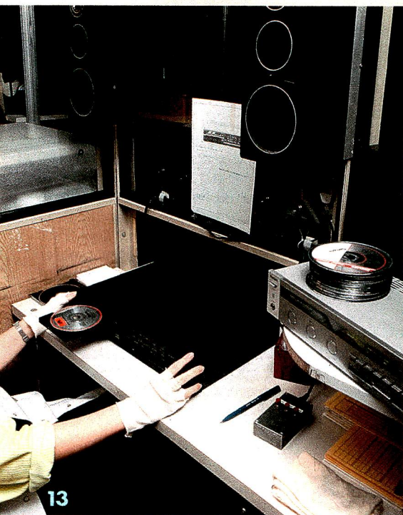
13. Dans des cabines insonorisées, les lecteurs subissent enfin un contrôle musical à l'aide d'un lecteur de référence. Ce contrôle se fait avant et après mise sous tension des lecteurs durant 24 heures.
