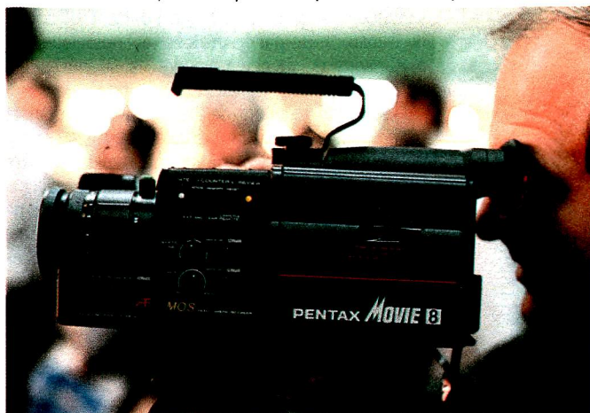
Le Pentax PV-C 800 E , caméscope 8 mm semblable au Kyocera, avec détecteur MOS, mise au point et exposition automatiques.
