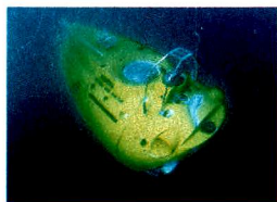
Le Nautil, qui plonge à - 6 000 m, est l'un des deux seuls sous-marins à permettre l'étude des grandes profondeurs.
