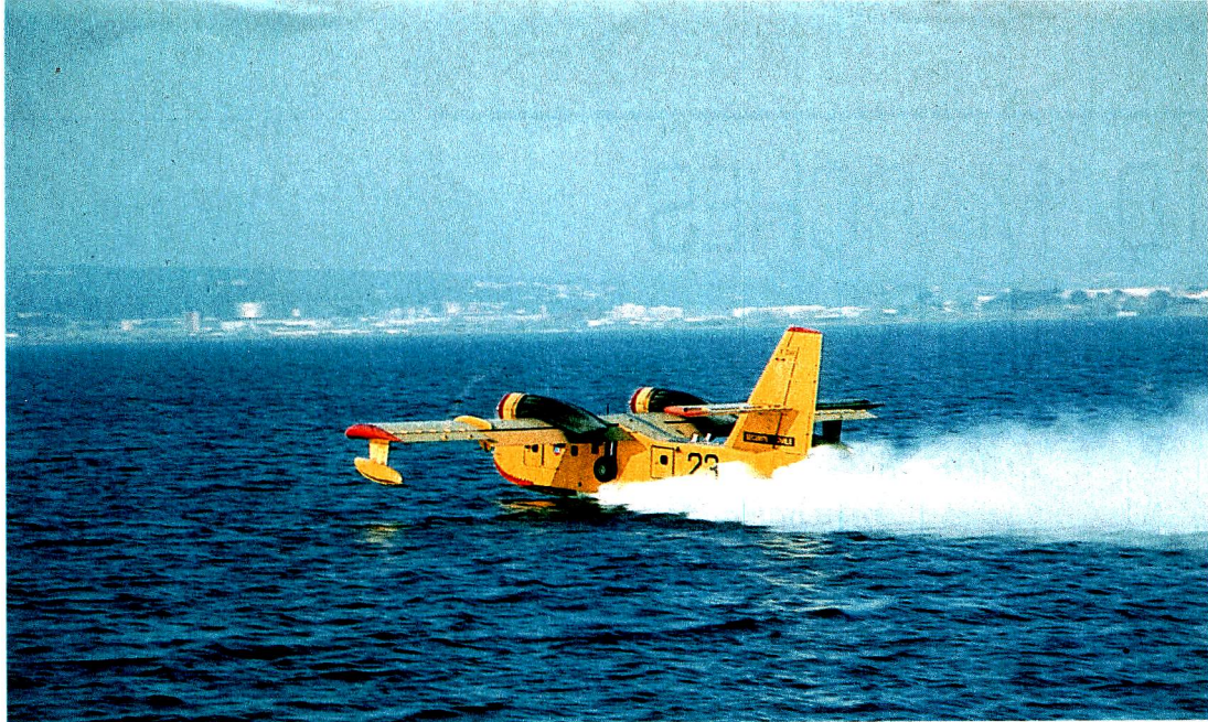
Quelques secondes d'écopage suffisent au Canadair (ci-dessus) pour remplir ses soutes d'eau, contre 7 minutes en moyenne d'immobilisation à la station de remplissage pour les avions-citernes "terrestres" comme le DC-6 (ci-contre).
