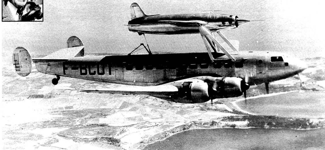
1949 : LE LEDUC 010 À STATORÉACTEUR VOLAIT DÉJÀ. L'avion de l'ingénieur français (encore un) René Leduc (ci-contre) est ainsi l'ancêtre de tous les projets d'avion hypersonique. Il est ici juché sur le dos d'un gros porteur, peu avant d'être lâché.
