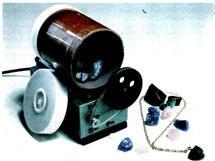
Le tonneau à polir et des pierres aux différents stade de polissage ; à droite un produit fini formant un collier.
