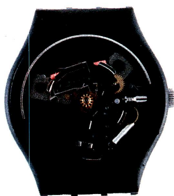
Sertissage du train réducteur et montage de la pile
