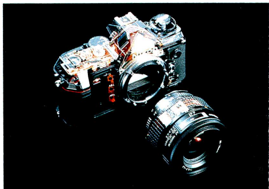
Le microordinateur du Nikon F-501 AF, entièrement monté sur support souple.
