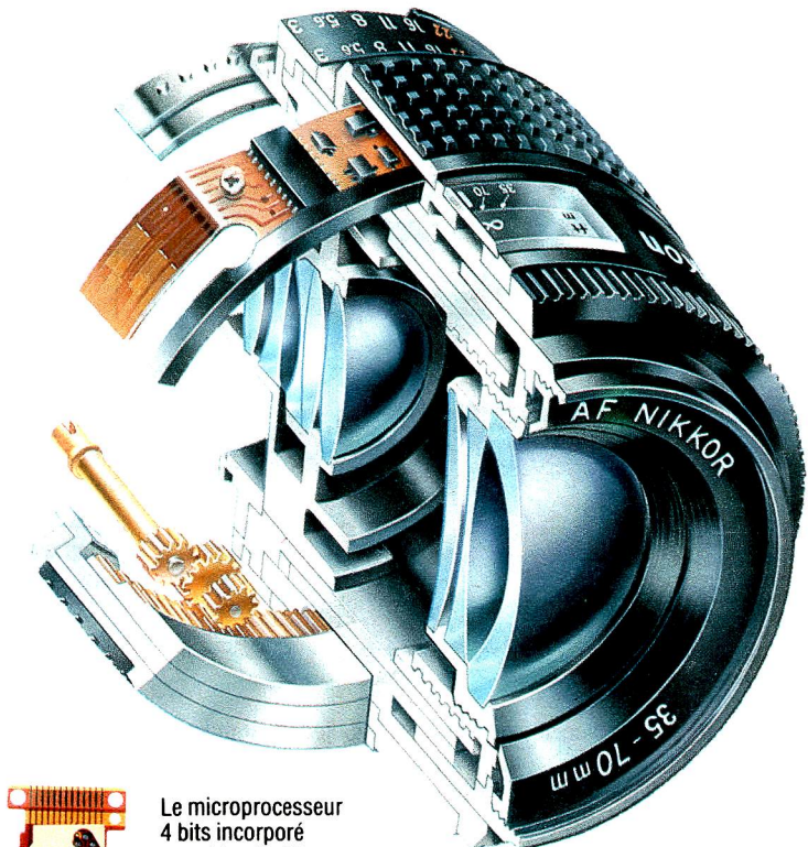
Coupe d'un objectif AF montrant le microprocesseur de mise au point automatique et une partie du train d'engrenages qui transmettent le mouvement du moteur de mise au point à l'objectif.
