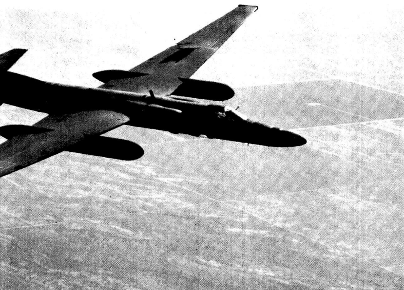
Le TR-1, deuxième avion-fantôme à "disparaître" au-dessus de la France, est un appareil de reconnaissance tactique équipé de caméras infrarouge et de radars spéciaux permettant d'observer le territoire ennemi, même par temps couvert.
