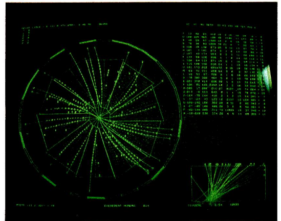
Reconstitution par ordinateur d'une collision entre une cible-plomb et des ions-projectiles relativistes. Les trajectoires des dizaines de particules éjectées dans toutes les directions ont été calculées à partir des données mesurées par le détecteur Diogène, puis retracées sur écran.
