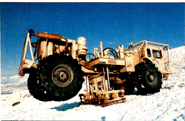
Pour faire trembler le sol, on utilise de puissants vibrateurs. Ici, l'un d'entre eux en action.
