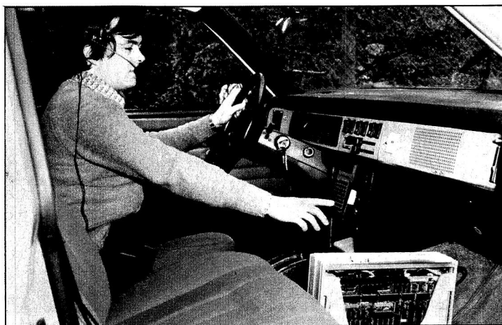
Le conducteur exprime ses ordres par un microcasque, mais on peut imaginer un micro logé au centre du volant. La programmation de la voix s'effectue sur le clavier central, qui a l'aspect d'une calculatrice.
