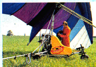
Le siège de l'Agriplane 2000 est moulé dans le réservoir séparé en deux compartiments : d'un côté le mélange deux-temps des moteurs ; de l'autre le produit de pulvérisation pour 2 à 3 hectares.
