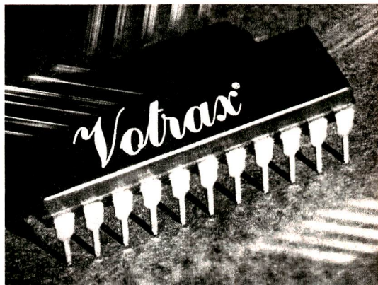
Le Votrax SC-01 est une « puce » capable de reconstituer un vocabulaire illimité à partir des sons élémentaires d'une langue (phonèmes et diphonèmes) enregistrés dans sa mémoire. Mis sur le marché fin 1980, il fera parler jouets, jeux, calculatrices, traducteurs, etc.
