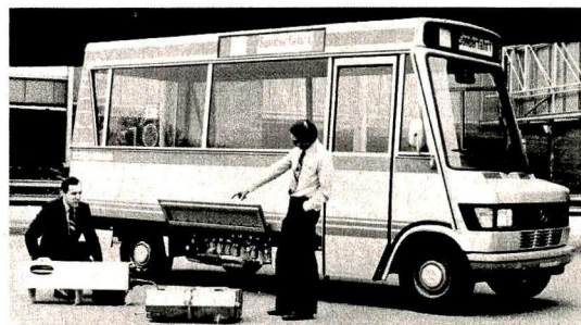
Le bus expérimental Mercedes-Benz utilise des accumulateurs d'hydrogène lui donnant une autonomie de 150 km.
